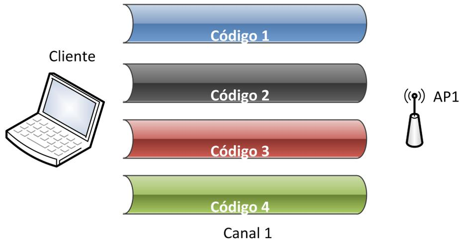
Figura 2.5: Representação do funcionamento da técnica de virtualização CDMA.
