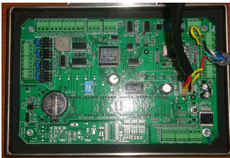
Figura 3.5. Circuito amplificador e placa de aquisição de dados.
