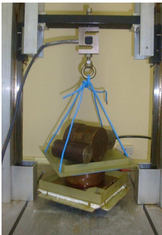
Figura 3.1. Calibração do indicador de pesagem, Peso = 11 kg.
