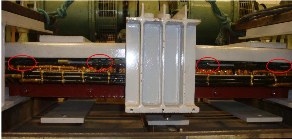
Figura 3.8. Calços e barras no largo do primário do motor linear.
