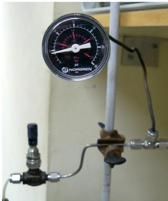
Figura 4.5 – Válvula micrométrica Hoke modelo *ss200* e manômetro Norgren modelo *18-013-214*
