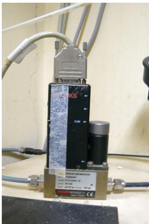
Figura 4.7 – Válvula controladora de vazão 5850S/BC Brookes
