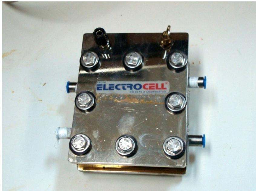
Figura 4.1 – Célula a Combustível unitária tipo PEM *FC25-1GH* fabricada pela Electrocell.
