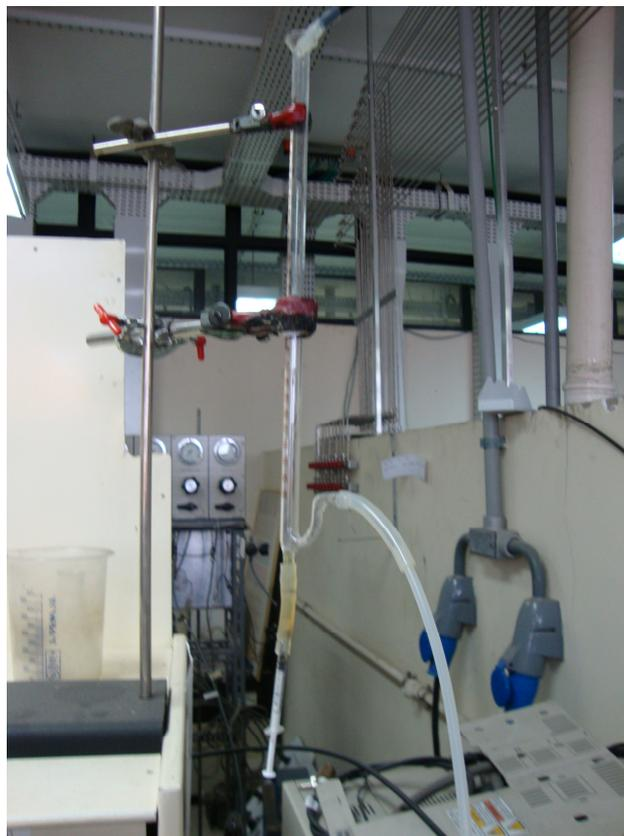
Figura 4.8 – Medidor de vazão de bolha de sabão
