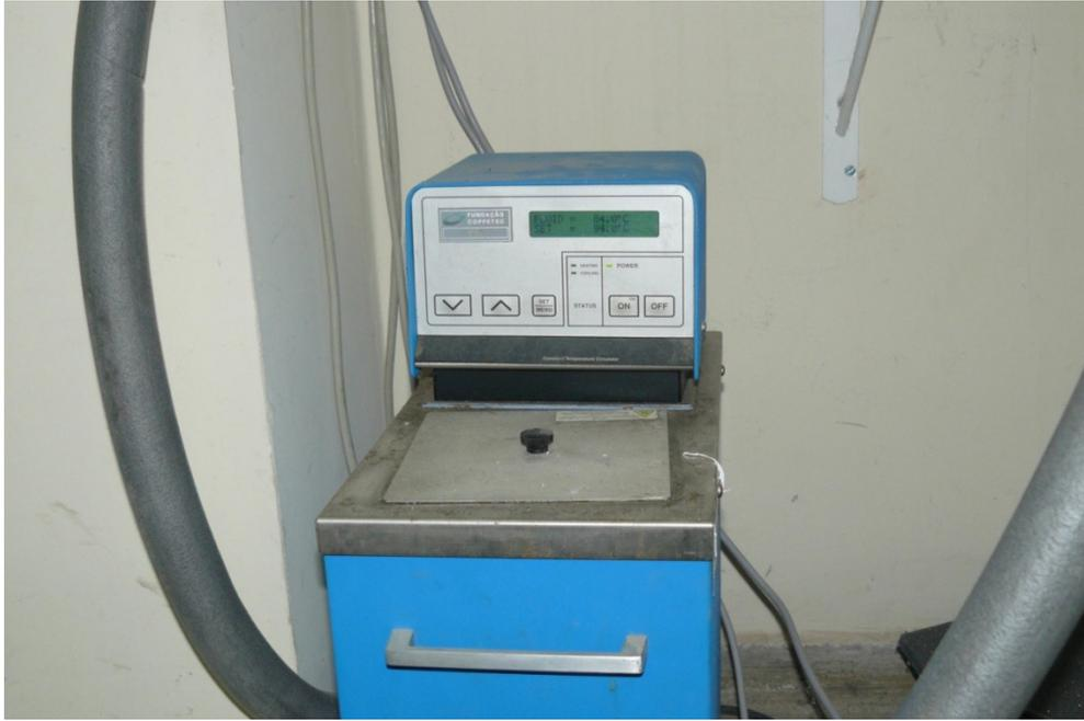
Figura 4.19 – Banho termostático modelo TBC2 fabricado pela SBS.
