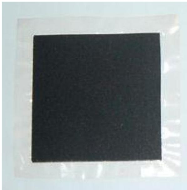
Figura 2.3 - Membrana típica de uma célula tipo PEM
