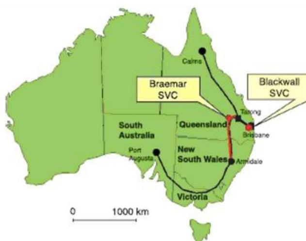
Figura 13 – Interconexão em 275/330/275 kV, Leste e Sul da Austrália<sup>16</sup>
