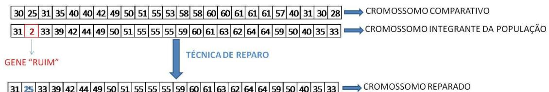
**Figura 5.3** – Processo executado pela técnica de reparo.
