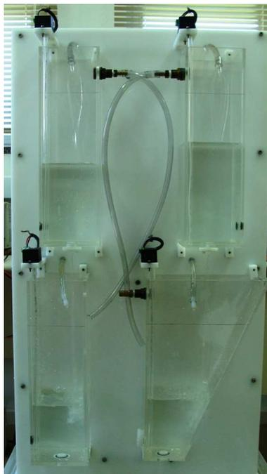
FIGURA 1.1: O sistema de quatro tanques.
