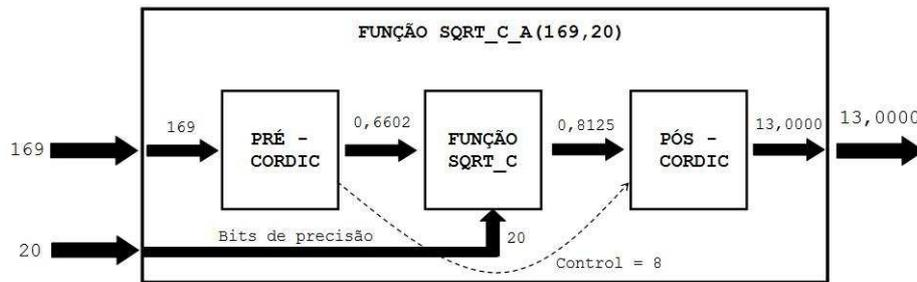
Figura 2.15: Esquemático da função *sqrt\_c\_a*.
