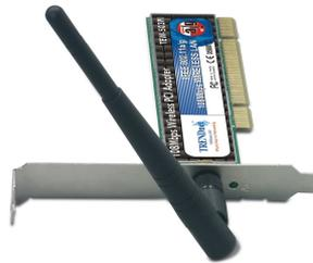
(a) Placa adaptadora com antena omnidirecional.
