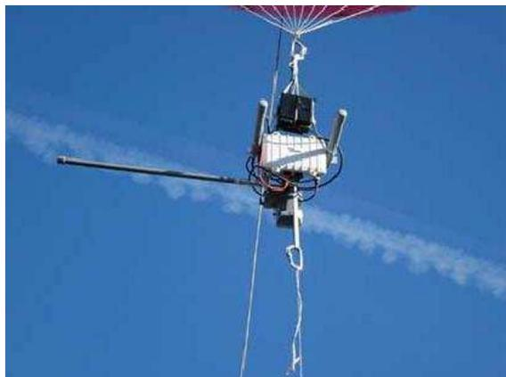
Figura 1.1: Exemplo de uso militar de antena omnidirecional em rede sem fio.
