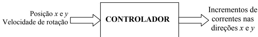
Figura 5.3: Parâmetros de entrada e saída do controlador.
