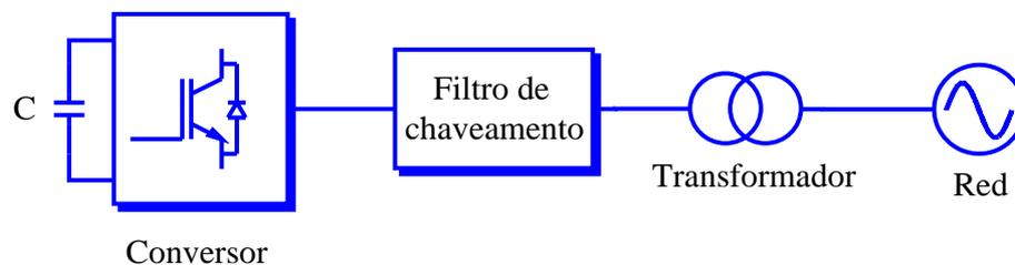
Figura 2.2: Diagrama unifilar simplificado de conexão do DSTATCOM.
