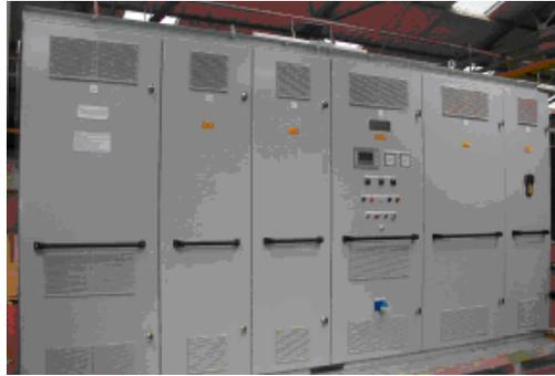
Fig. 33: Sistema Conversor (VSC-PWM).
