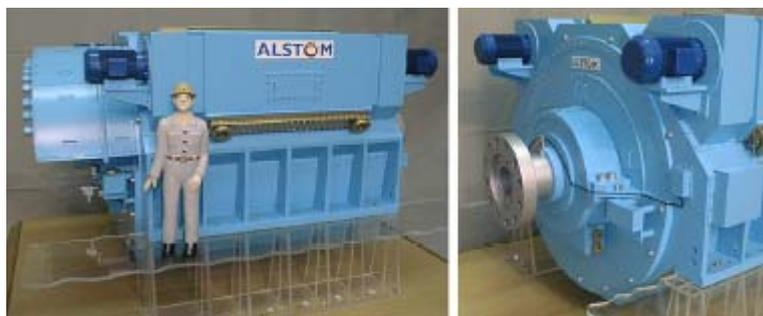
Fig. 39: O Motor de Indução Avançado (Multifásico com 15 fases).
