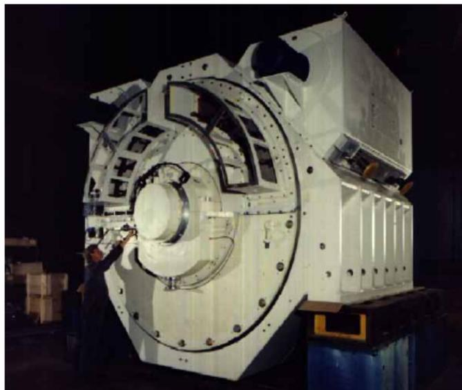
Fig. 5: Motor de Indução Avançado (AIM) comparado a uma pessoa.
