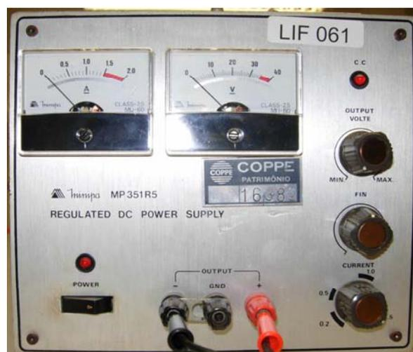
**Figura 4.11:** Fonte do microventilador.
