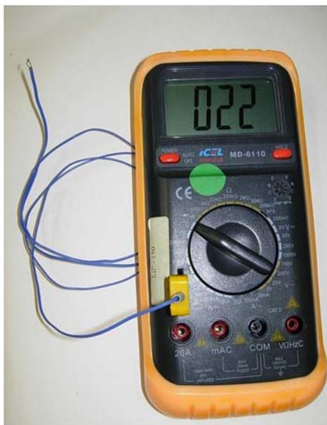
**Figura 4.18:** Conjunto Termopar e Indicador de Temperatura.
