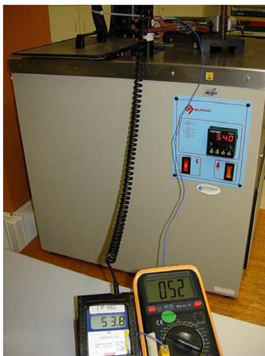
**Figura 4.19:** Calibração de termopar.
