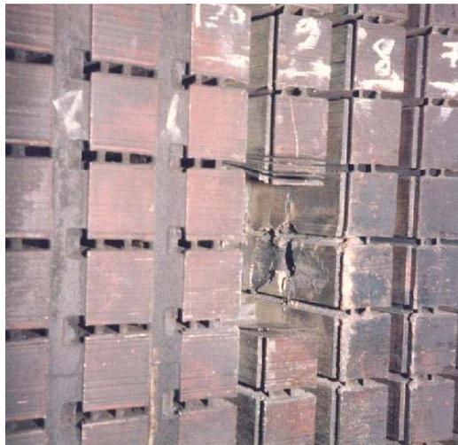
Figura 2.1.3 – Ponto de falha entre espiras do enrolamento estático da UG#1 da USLB.O.
