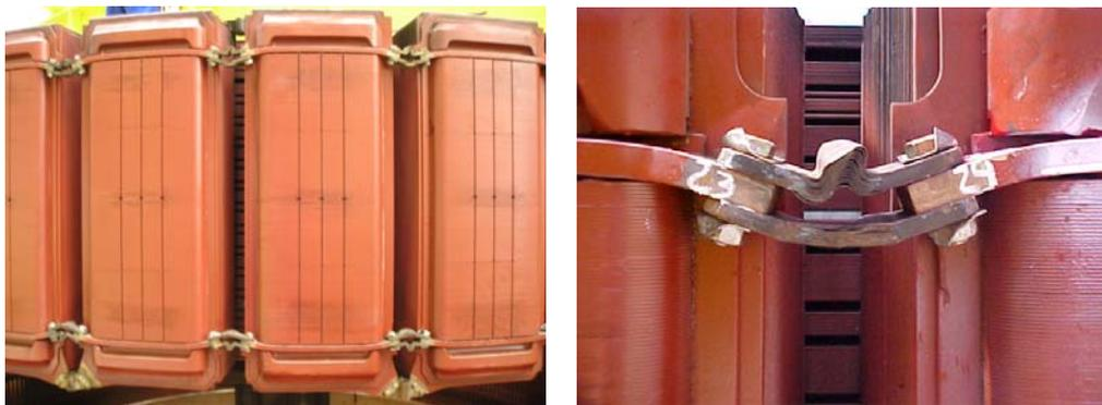
Figura 3.4.1.2. – Danos às conexões dos pólos após a ocorrência.
