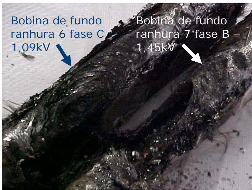
Figura 3.4.1.1. – Estado das bobinas da Unidade após a ocorrência.
