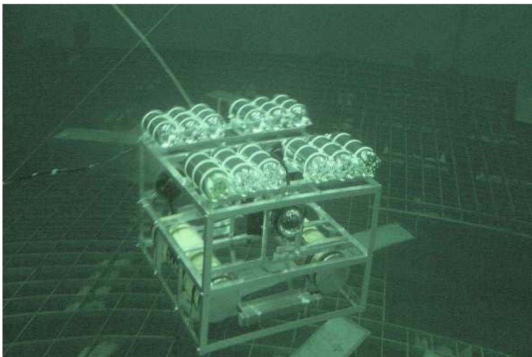
FIGURA A.1: ROV LUMA no tanque do Laboratório Oceânico da UFRJ.
