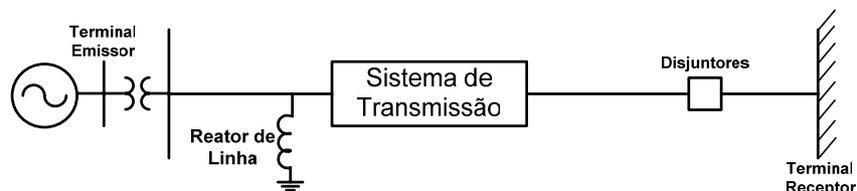
**Figura 45- Representação da linha de transmissão num estudo de rejeição de carga**
