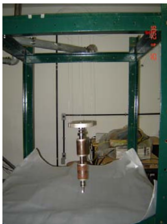
Fig. 2 – Da esquerda para direita, fotos: - Sistema de ensaio: fio, rotor e disco. - Rotor
