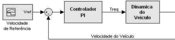
FIGURA 5.2: Diagrama de blocos da dinâmica do veículo com a adição de um controlador PI.
