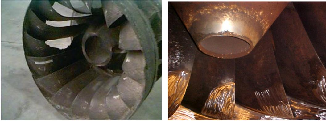
(a) Turbina avariada devido ao efeito de cavitação.
