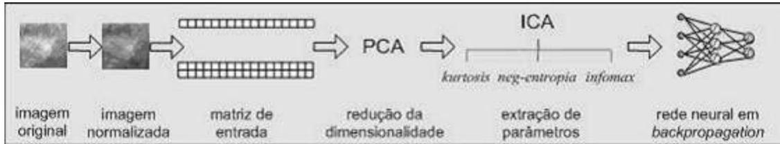
**Figura 6.2 – Desenho Esquemático: ICA + *backpropagation***
