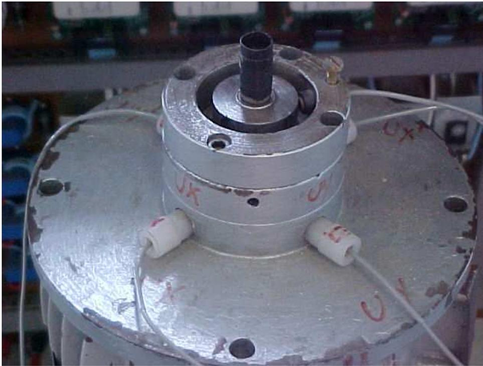
Figura B.4: Detalhe dos sensores de posicionamento
