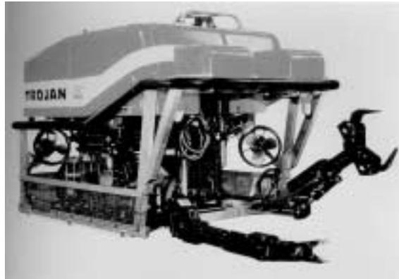
FIGURA 6.4: Veículo de intervenção submarina ROV/Manipulador
