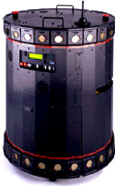
FIGURA 5.4: A plataforma móvel, Nomad XR-4000.
